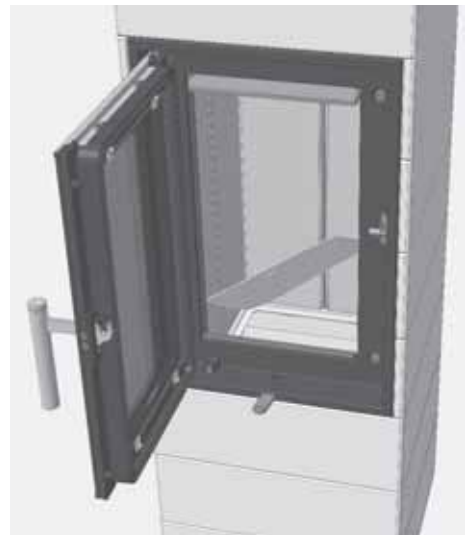
Abb. 4.14 Entnehmen des Bodenblechs im Brennraum
