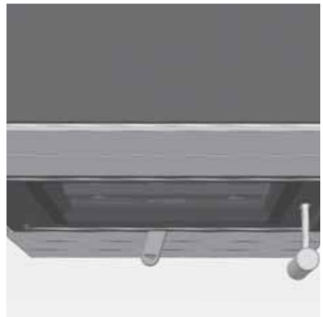
Abb. 4.7 Verbrennungslufthebel ganz links, Verbrennungsluft geschlossen
