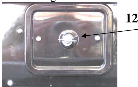
Hinter der Putztürblende befindet sich der Putzdeckel (Abbildung 6, Position 12). Dieser ist mit 1 Flügelmutter an der Herdfront befestigt und muss zum reinigen der Heizzüge abgenommen werden. Vor dem Wiederanschrauben ist die Dichtschnur am Putzdeckel auf Dichtheit zu kontrollieren und bei Bedarf auszuwechseln.
