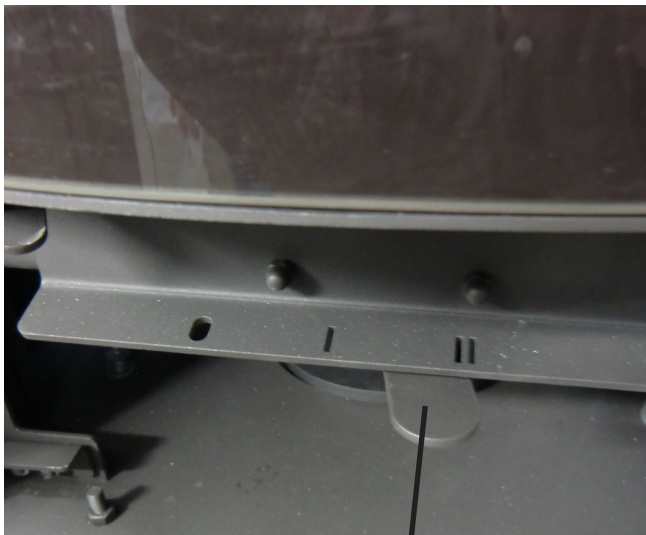
Levier de commande pour l'alimentation en air de combustion
